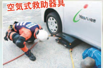
空気を送り、エアーマットを膨張させて、車などの重量物を持ち上げたり、間隔を広げたりして挟まった人を救助します。
