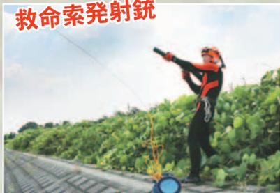
川の中洲に取り残された人を救助するために、圧縮空気を利用した発射銃で救助ロープや浮輪を届けます。
