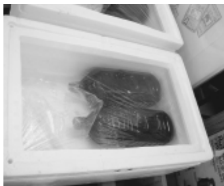
太陽熱を利用した湯沸かし器
