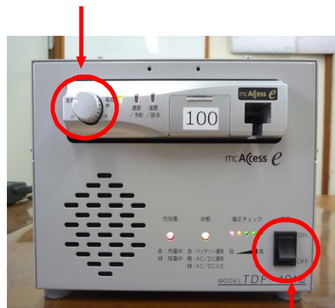
主電源(常時on)
