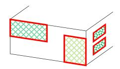
壁面緑化面積 = 壁の正面から見た際の 中で囲われた部分の面積 (鉛直投影面積)
